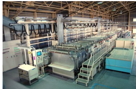
自動めっき設備
