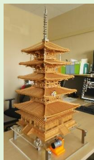
自作加振器による五重塔の振動特性評価
