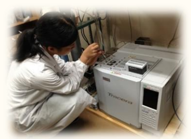
ガスクロマトグラフを用いて反応の進行度を分析します。
